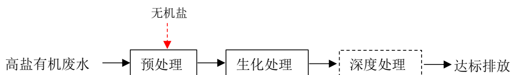
图 2 “预处理+生化处理+深度处理”工艺流程图
